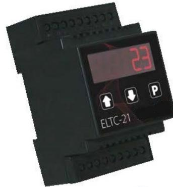
Mit digitalem Display für die Hutschienenmontage. Die mit einem Temperaturfühler Pt100 gemessene Temperatur wird von einem Mikrocontroller verarbeitet und angezeigt. Nach Ist- / Sollwertvergleich werden die Ausgangsrelais geschaltet.
