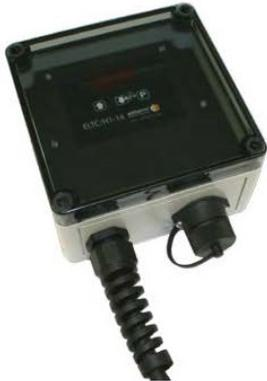
Mit digitalem Display für die Wandmontage. Die per Temperaturfühler PT-100 gemessene Temperatur wird von einem Micro Controller verarbeitet und angezeigt. Nach Ist- / Sollwertvergleich werden die Ausgangsrelais geschaltet. Das Gerät ist mit Einbaubuchsen, spritzwassergeschütztem Kunststoffgehäuse und transparentem Gehäusedeckel ausgestattet.
